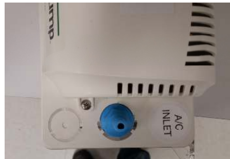
Figure 2 – Entrée AC (air climatisé) située à côté du clapet antiretour sur le dessus du NT1-P
